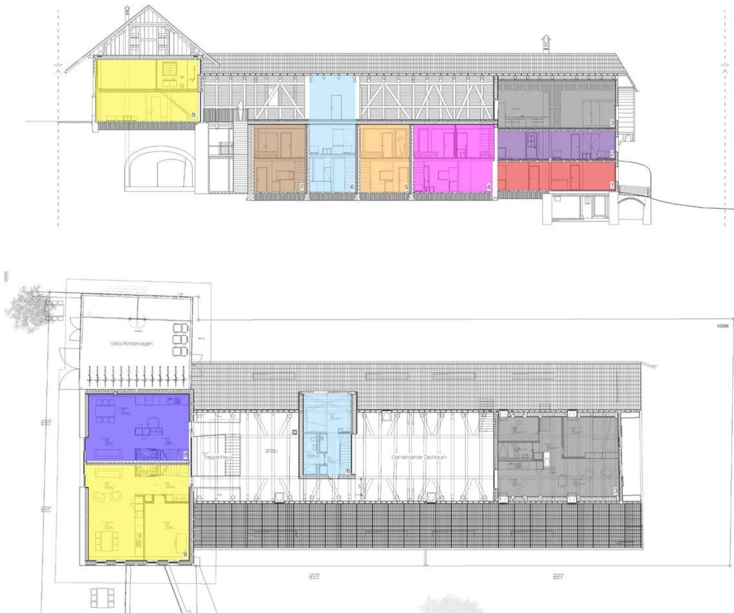
Répartition des logements. Coupe et plan d'étage des combles
